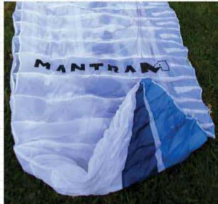
Profil şeklini muhafaza etmek için hücum kenarı üzerinde kullanılan ekstra bantlar
